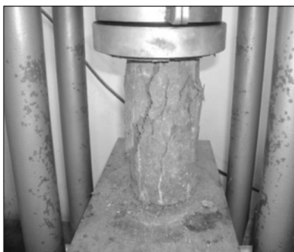
Figura 10. Corpo-de-prova Submetido a uma Força Axial.
