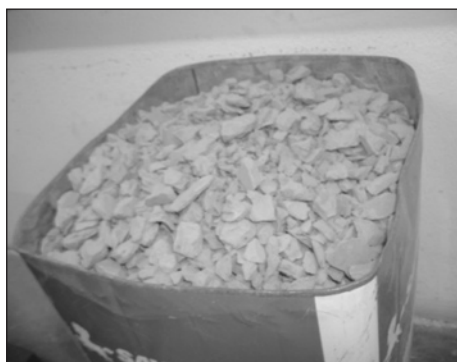
Figura 6. Agregado Miúdo Produzido com Telha Cerâmica Vermelha Usada.
