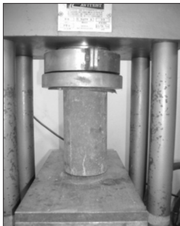
Figura 10. Corpo-de-prova Submetido a uma Força Axial.
