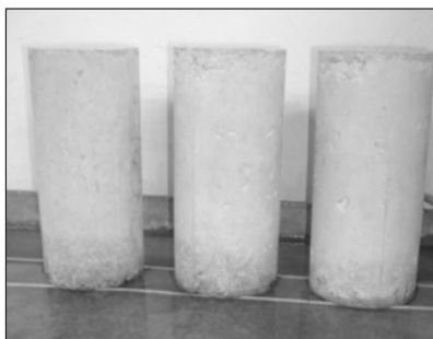
Figura 16. Realização do Ensaio de Absorção por Capilaridade.
