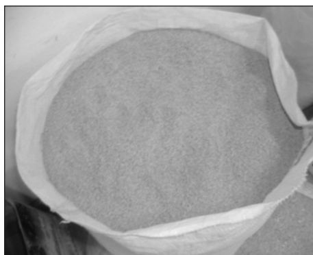
Figura 6. Agregado Miúdo Produzido com Telha Cerâmica Vermelha Usada.
