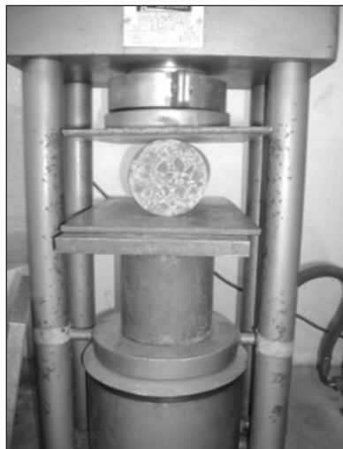
Figura 12. Concreto Sendo Submetido a uma Força Diametral.
