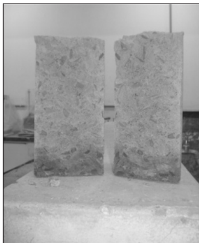
Figura 17. Altura Capilar do Concreto Reciclado ( h = 5 cm).
