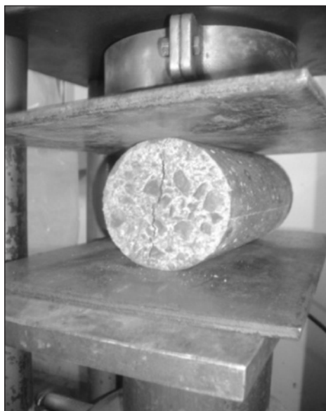
Figura 13. Concreto Rompido por uma Força Diametral.
