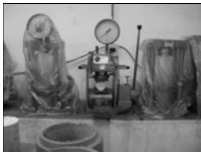
b) Ruptura diametral dos corpos-de-prova.
