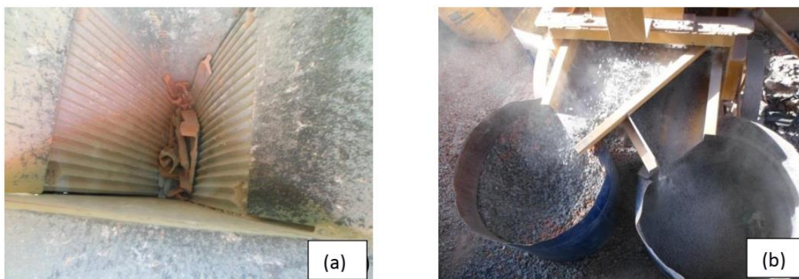
Figura 1 – RCD lançado no britador (a); separação do agregados graúdos e miúdos após britagem (b).
