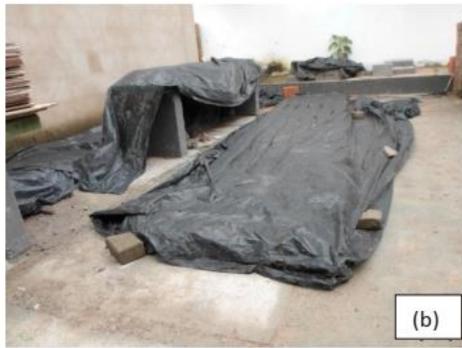
Figura 6 – Blocos na área de cura (a); lona preta cobrindo os blocos (b); molhagem dos blocos (c) empilhamento dos blocos após o período de cura (d).
