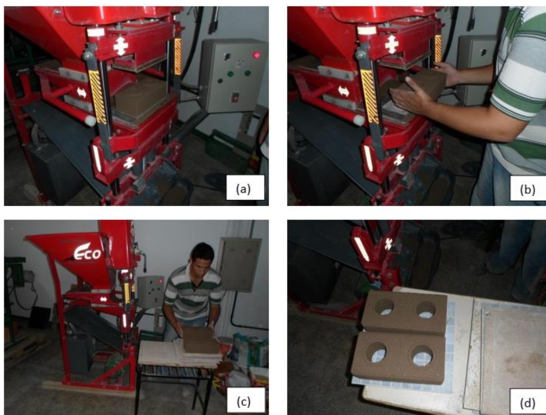
Figura 5 – Prensagem do bloco (a); extração do bloco (b); posicionamento do bloco na placa cerâmica (c); blocos prontos para serem levados à área de cura (d)
