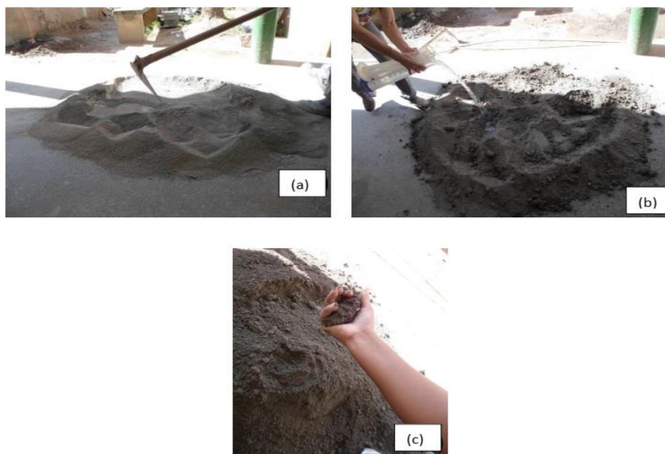
Figura 4 – (a) mistura entre os materiais secos (agregados e cimento); (b) mistura de todos os materiais secos com a água (b); teste tátil-visual (c).
