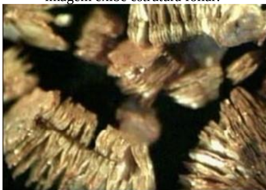
Figura 11 – Vermiculita expandida : imagem exibe estrutura foliar.
