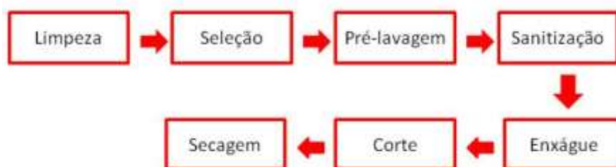
Figura 1 – Fluxograma do processo de preparo da matéria-prima.
