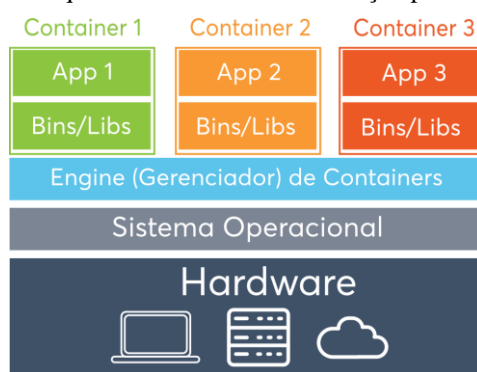
Figura 2. Arquitetura básica da virtualização por containers
