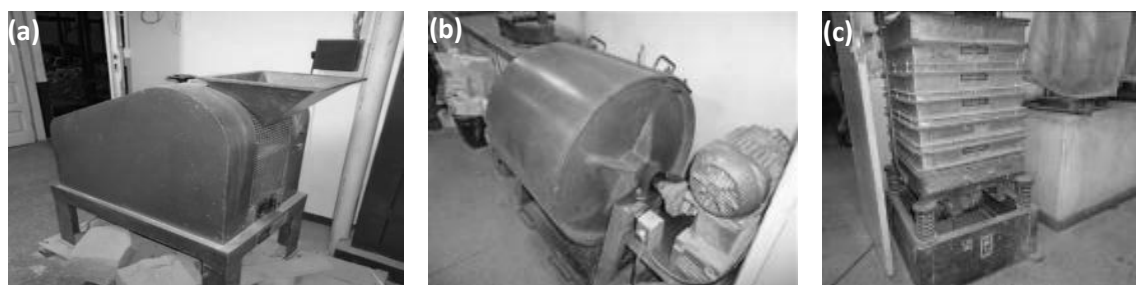
Figura 5 - Equipamentos para o processamento dos agregados; (a) britador de mandíbula; (b) moinho de bolas; (c) conjunto de peneiras
