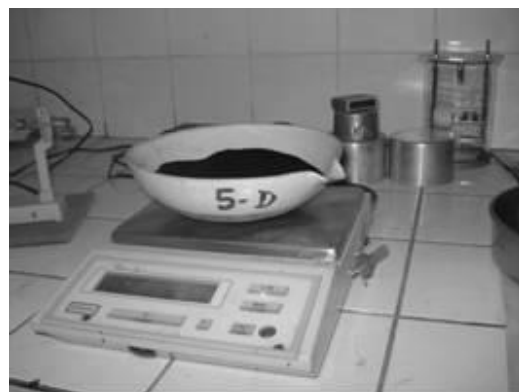
Figura 6. Borracha peneirada sendo pesada.
