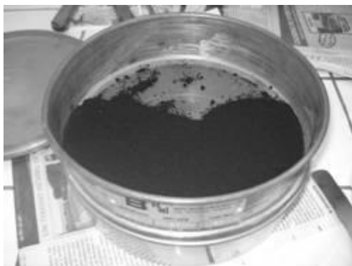
Figura 3. Borracha sendo peneirada.
