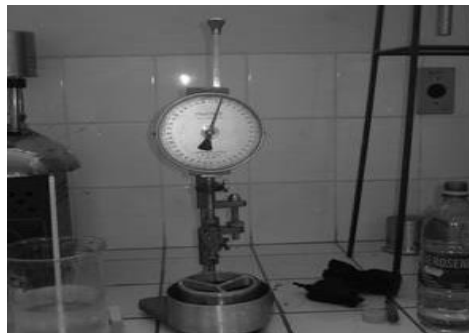
Figura 10. Detalhe do andamento do ensaio de penetração.
