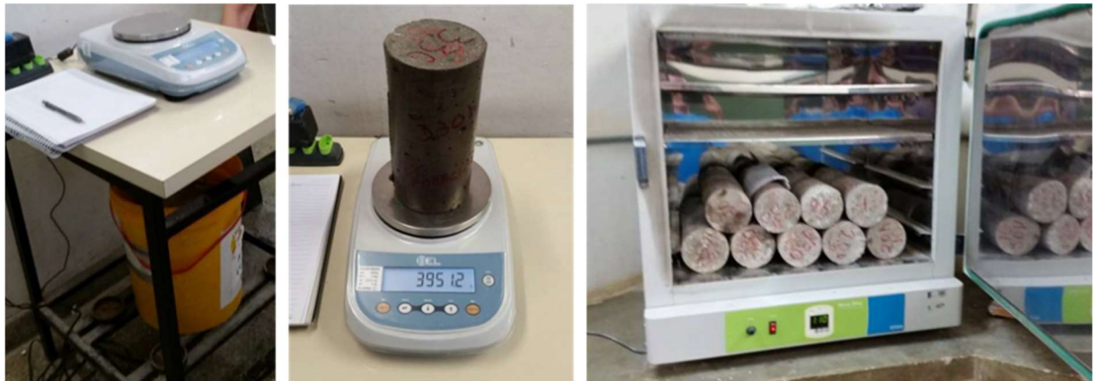
Figura 5 - Ensaio de absorção de água por imersão
