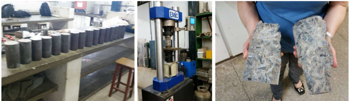
Figura 6 - Ensaio de resistência à compressão axial
