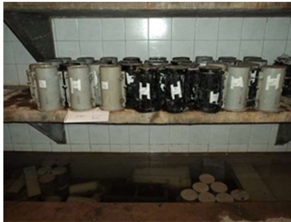
Figura 4 - Corpos-de-prova na câmara climatizada
