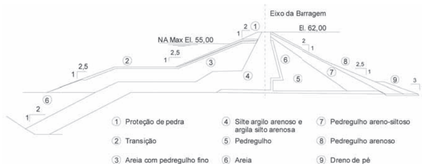
Figura 3. Seção Típica Modificada da Barragem de Açú.
