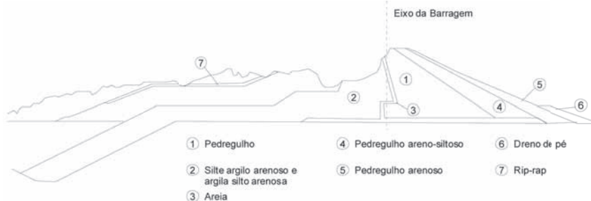
Figura 4. Seção da Barragem de Açu após Ruptura.
