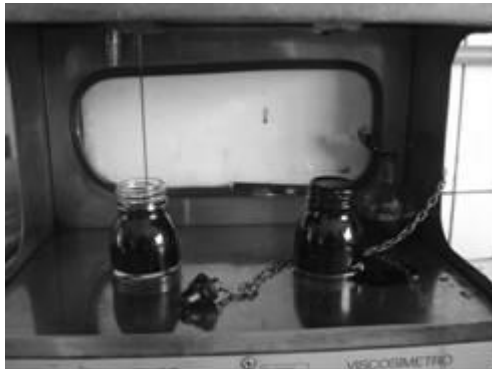
Figura 11. Detalhe do andamento do ensaio de viscosidade Saybolt-Furol.
