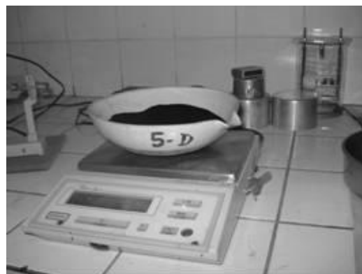
Figura 8. Incorporação da borracha ao CAP.
