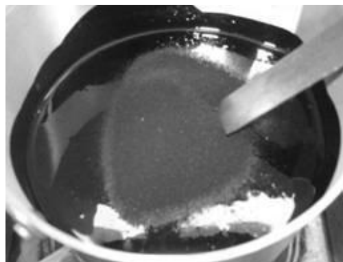
Figura 8. Incorporação da borracha ao CAP.
