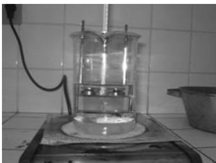
Figura 9. Detalhe do andamento do ensaio de ponto de amolecimento.
