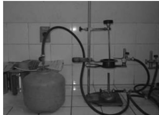
Figura 12. Detalhe do andamento do ensaio de ponto de fulgor.
